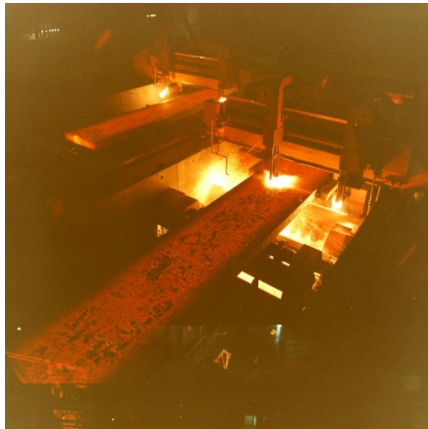
Première installation de coulée continue à Usinor Dunkerque (1969)
